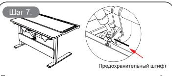
Плотно закрепите все винты и выньте предохранительный штифт из газ-лифта (F). Примечание. Если не удалить штифт, настройка высоты не будет функционировать.
