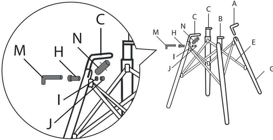
Вставьте деталь C в разрез на ножке, с помощью болта H. Соедините металлический каркас стула с ножкой, после чего затяните гайку I шестигранником M, удерживая гайку ключом N.
