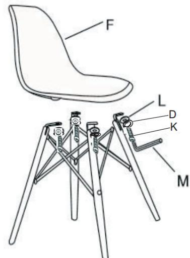
Расположите сиденье на ножках таким образом, чтобы отверстия совпали. Используя шайбы L, затяните болты K с помощью шестигранника M.
