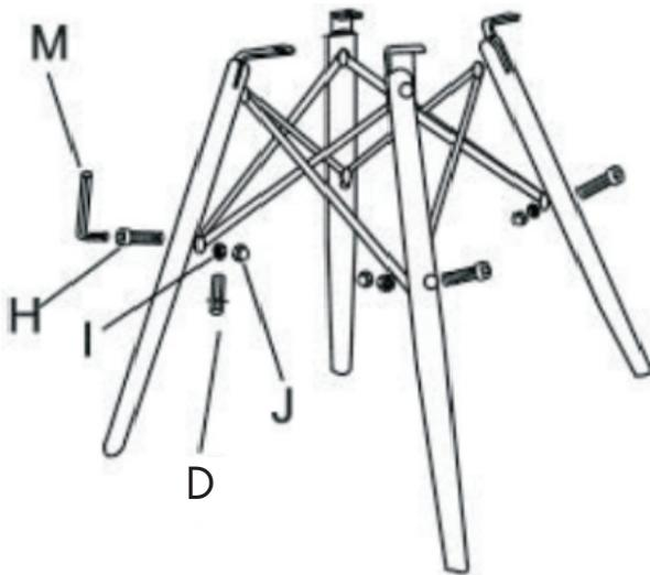
Таким же образом закрепите нижнюю часть металлического каркаса к ножкам.
